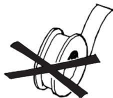
NO utilice cinta de rosca en las conexiones del tubo.
