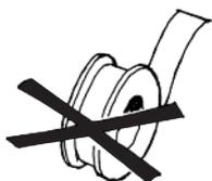
NO utilice cinta de rosca en las conexiones del tubo de bombeo.
