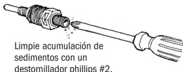
Inspecciones y limpiezas periódicas del punto de inyección mantendrán al dosificador funcionando correctamente y extenderá la vida útil del tubo de bombeo.
