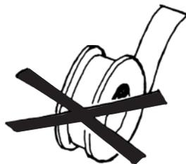
NO utilice cinta de rosca en las conexiones del tubo de bombeo
