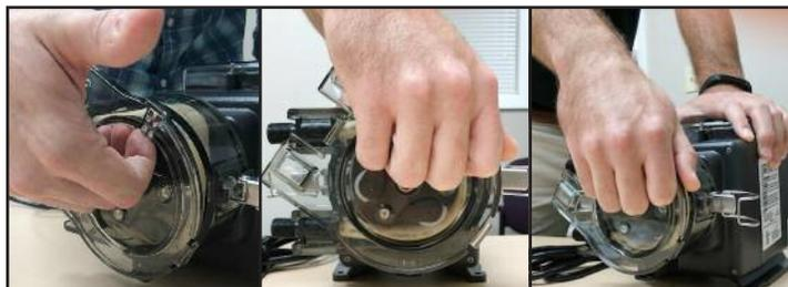
Sujete firmemente el motor con una mano. Con la otra mano, sostenga la cubierta de la carcasa del tubo con los dedos dentro del borde superior de la cubierta. Utilice la cubierta como una herramienta y con la palma de la mano gire rápidamente la cubierta en sentido antihorario para colapsar el conjunto de rodillos. El tubo ya no estará presionado contra la pared de la carcasa.
