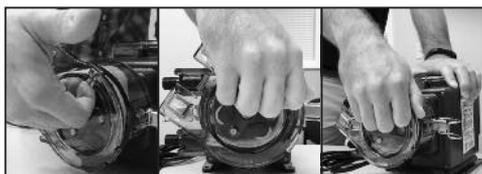
Sujete firmemente el motor con una mano. Con la otra mano, sostenga la cubierta del cabezal colocando los dedos dentro del borde superior de la misma. Utilice la cubierta como una llave y con la palma de la mano gire la misma de forma rápida en sentido antihorario para colapsar el conjunto de rodillos. El tubo ya no estará presionado contra la pared de la carcasa. **Ir al punto #7.**
