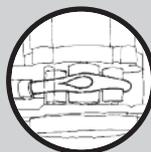
**NUEVO DISEÑO DEL CABEZAL.** El conjunto de rodillos se colapsa y expande. Pevio a encender el dosificador, **CONFIRME QUE EL CONJUNTO DE RODILLOS ESTE EXPANDIDO** y que el tubo esté presionado contra la pared del cabezal.
