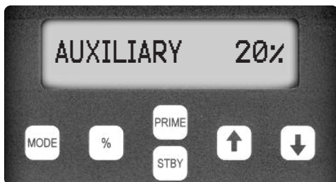
Ejemplo del panel de control establecido al 20%.
