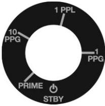
El Stennicator requiere una señal de un medidor de agua que proporcione un contacto seco configurado a 1 PPG, 10 PPG o 1 PPL. Este dosificará proporcionalmente con una relación de 1:128 (1 oz. por galón) para tratar las proporciones de flujo del proceso hasta 2.7 gpm\*. En cualquier momento el potenciómetro puede cambiarse a la configuración adecuada de velocidad de contacto (1 PPG, 10 PPG, o 1 PPL), para lograr la dosificación proporcional de 1:128.
