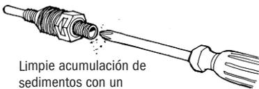
Inspecciones y limpiezas periódicas del punto de inyección mantendrán al dosificador funcionando correctamente y extenderá la vida útil del tubo de bombeo.
